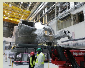
Un élément de chambre à vide à monter sur secteur
